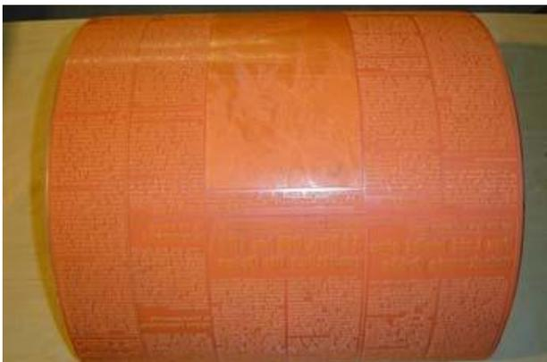
La flexografía, es un proceso que **deriva de la impresión en tipografía y utiliza planchas flexibles de fotopolímero** y tintas fluidas a base de agua que se secan por evaporación a veces asistidas por calor.
